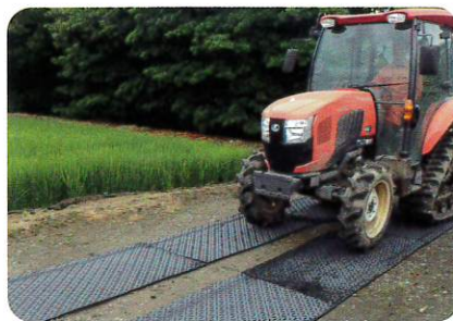
農機走行の路面養生
